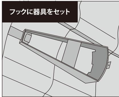
**設置方法** 上の図の様に、上段の瓦を少し持ち上げてフックを差し込み瓦浅に引っ掛けてください。
